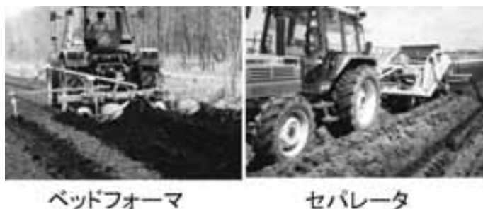
図3 ソイルコンディショニング技術で使用するトラクターのアタッチメント
