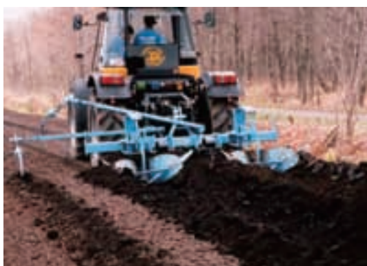
ベッドフォーマによる土寄せ作業
